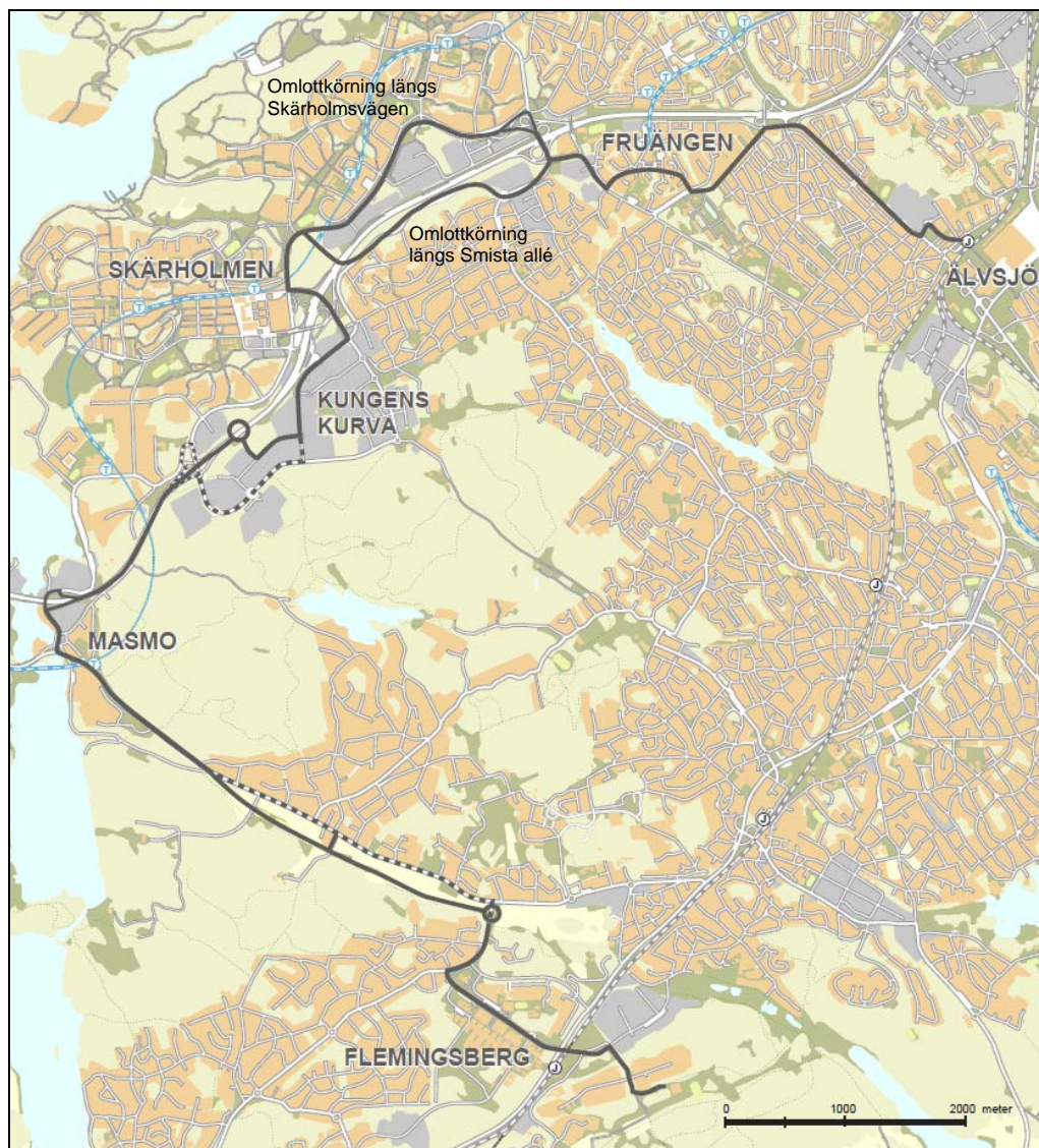
Figur 12 Studerad körväg för ett bussalternativ. Streckad dragning visar på möjlig trafikering utifrån dagens infrastruktur. Vid ett senare tidsskede då cirkulationsplatsen norr om trafikplats Lindvreten samt Södertörnsleden kan användas bör istället de trafikeras (heldragen linje). För att försörja större områden med kollektivtrafik föreslås en omlottkörning mellan Skärholmen och Fruängen. Det innebär att varannan buss trafikerar Smista allé och varannan trafikerar Skärholmsvägen. En dragning längs Smista allé enligt figuren förutsätter en ny bussbro över E4 till Skärholmsvägen.
