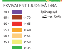
6.6.5. Ekvivalent ljudnivå från vägtrafik, 2 meter över mark. Figuren härrör från Huddinge kommuns bullerkartläggningen.
